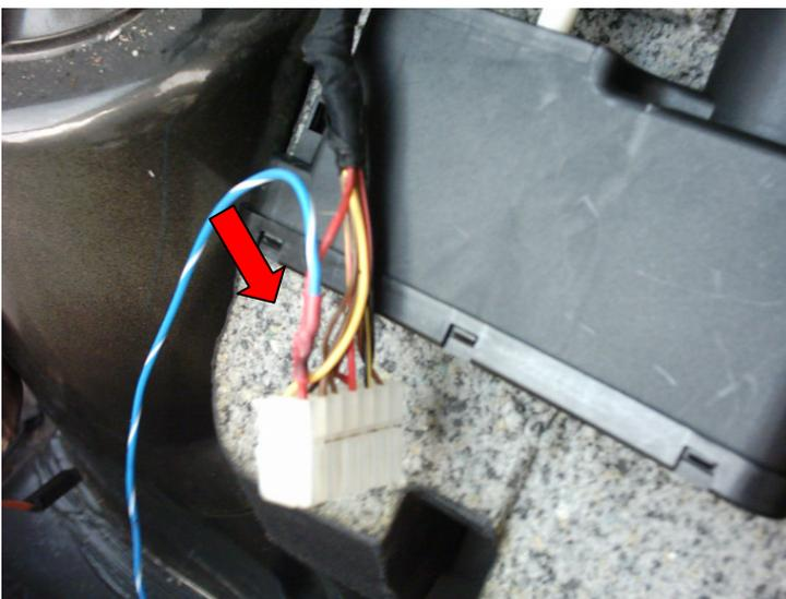
Hier sieht man ein zusätzlich mit angelötetes Kabel. Die Lötstelle muss mit einem Schrumpfschlauch isoliert werden!
