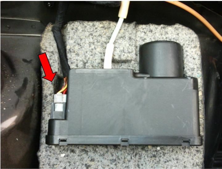
An diesen Stecker werden drei Leitungen für die neue Empfangseinheit (Pin-Nr. 11, 14 und 15) mit angelötet. Pin-Nummern dieses Steckers sind 10, 1, 7 (siehe Tabelle).
