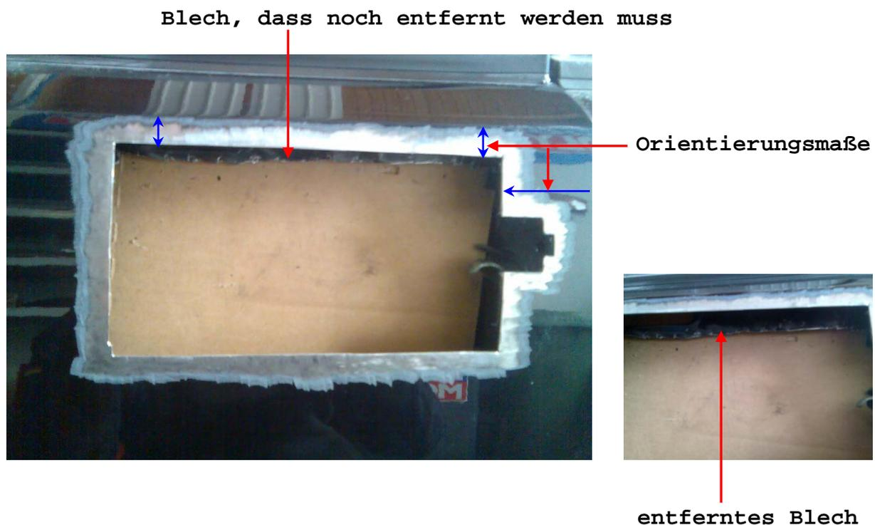
Auf dem Bild ist ein Blech zu erkennen, Das noch im Weg ist und entfernt werden muss. Hierzu habe ich einen „Dremel“ mit einer flexiblen Welle verwendet. Man muss halt ein wenig probieren, bis es einwandfrei passt und genügend platz für die spätere Griffmulde und den Griff selbst vorhanden ist. Lieber schneidet man ein klein wenig zuviel aus, als dass man später dauernd nacharbeiten muss.
