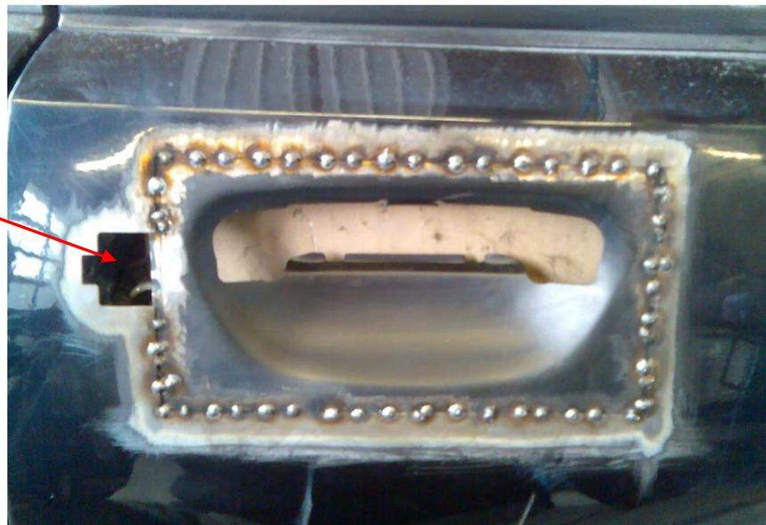
Auf dem Bild ist zu erkennen, dass noch ein kleines Stück frei bleibt, in Welches ein kleines Blech geschweißt werden muss.
